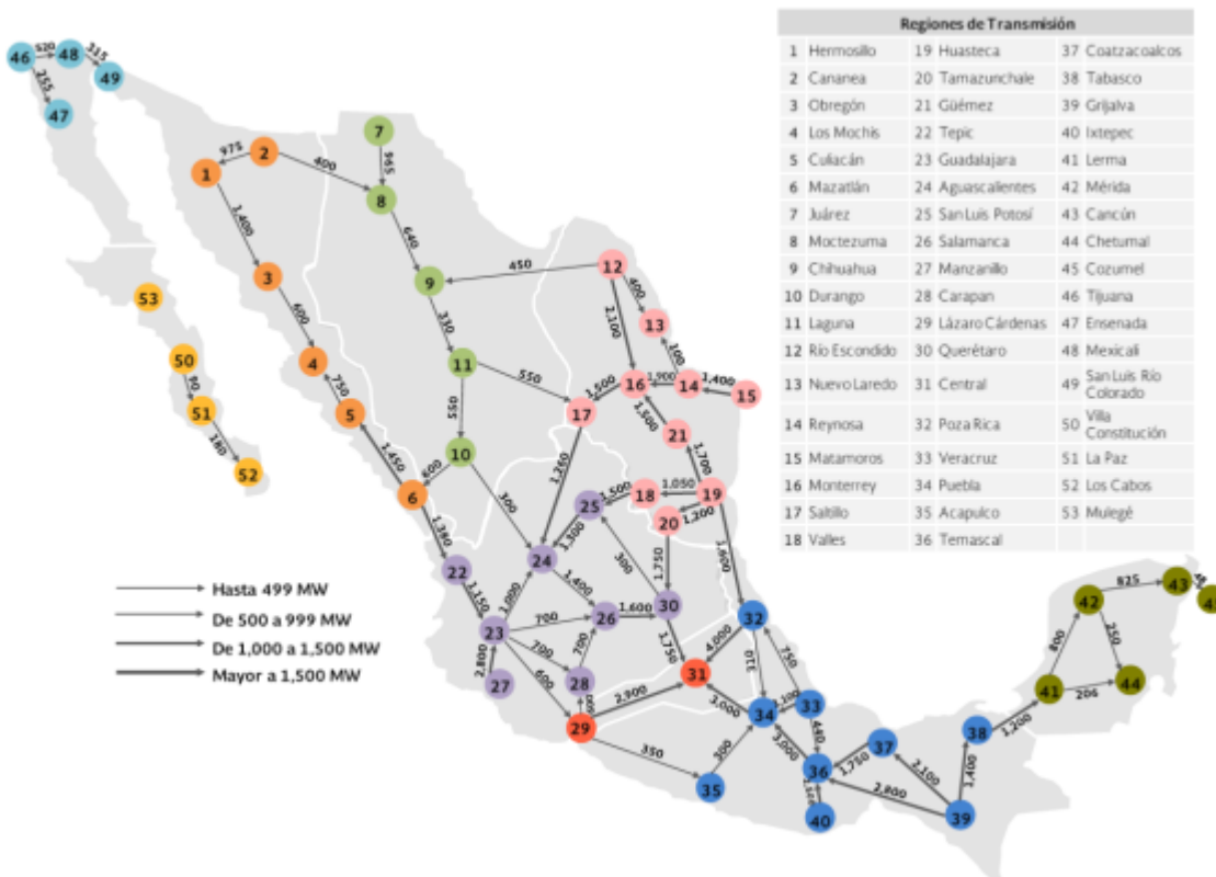
Ilustración 2. Capacidad de enlaces entre las 53 regiones de transmisión del SEN 2017
